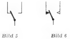
Bild 5. Darstellung von Relaiskontakten nach DIN 40700
